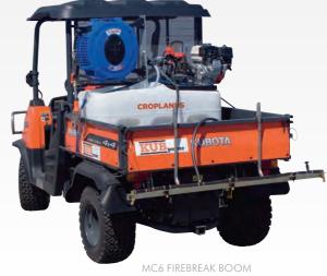
MC6 FIREBREAK BOOM SHOWN FITTED TO TRAY
